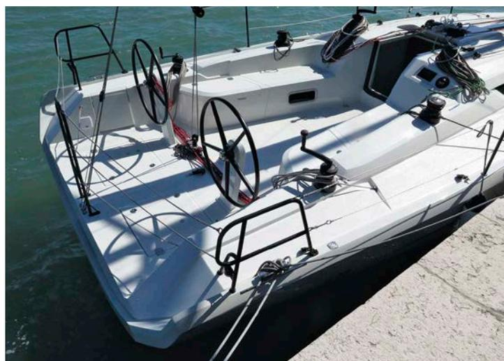
**Ouvert.** Le cockpit est dessiné pour faciliter la manœuvre en équipage avec des hiloires faciles à franchir et confortables pour s'y asseoir au vent.
