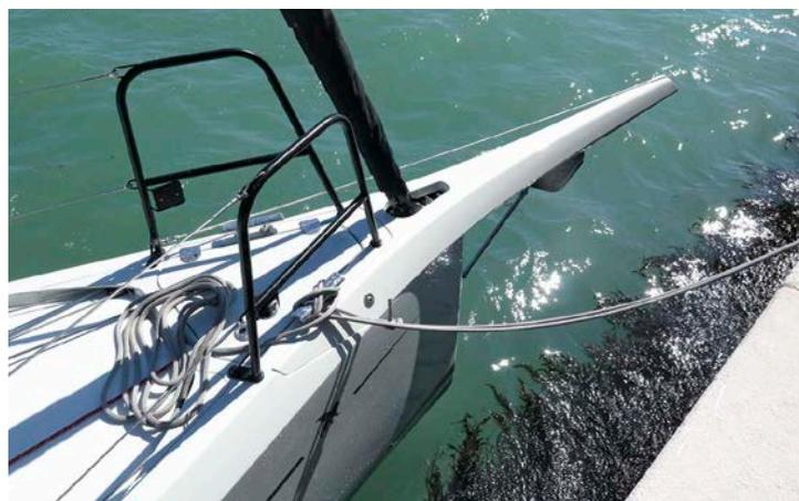
**Modulable.** La longueur du bout-dehors est au choix du propriétaire. Ici un modèle intermédiaire qui supporte aussi le mouillage. L'enrouleur est sous le pont.
