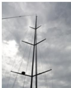
► L'albero in carbonio è un plus importante per la barca. Questo oltre ad alleggerire il peso totale della barca, leva peso dalla parte alta e la barca è più stabile
